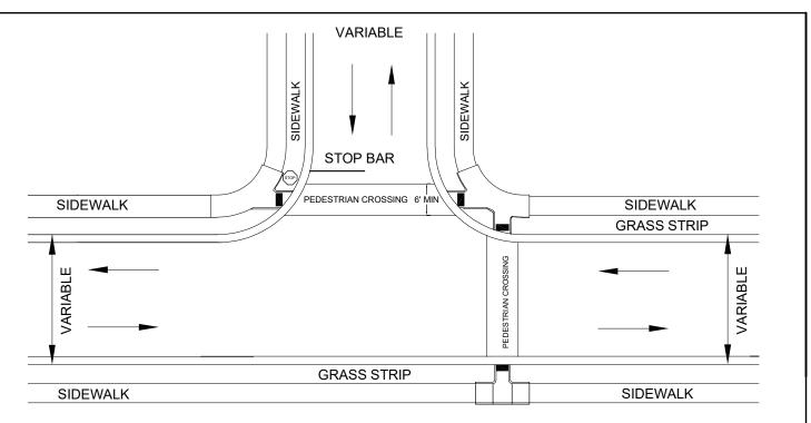
DETAIL SHOWING TYPICAL LOCATION OF SIDEWALK ACCESS RAMPS
