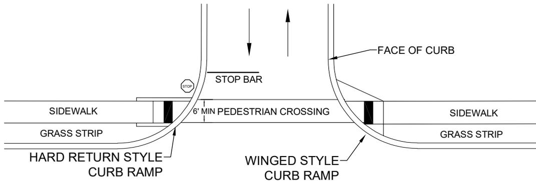
DETAIL SHOWING TYPICAL LOCATION OF SIDEWALK ACCESS RAMPS
